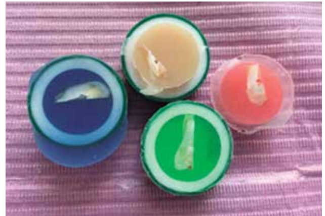
Figura 3. Muestra los tubos de propileno necesarios para suspender las probetas.
